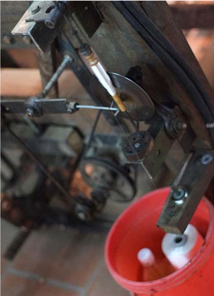
Việc cuốn tơ vào con thoi cũng được thực hiện ngay trên giàn cửi. Mỗi một lõi tơ này khi lắp vào con thoi sẽ dệt được một gang tay lụa với khổ ngang 1m. --- Các hoa văn trên lụa được tạo nên từ những mẫu như thế này.
