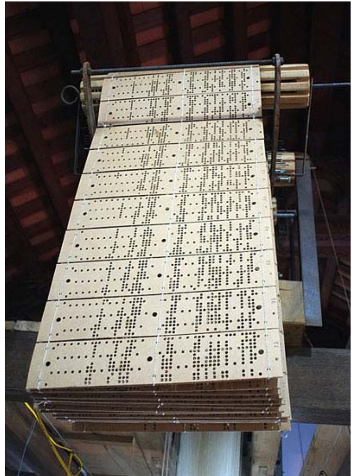
Việc cuốn tơ vào con thoi cũng được thực hiện ngay trên giàn cửi. Mỗi một lõi tơ này khi lắp vào con thoi sẽ dệt được một gang tay lụa với khổ ngang 1m. --- Các hoa văn trên lụa được tạo nên từ những mẫu như thế này.
